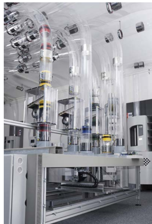
Figura 5. Sistema di interscambio di gruppi di bossoli navicelle provenienti dall'alto e che ripartono verso l'alto in nuove linee (Aerocom).
